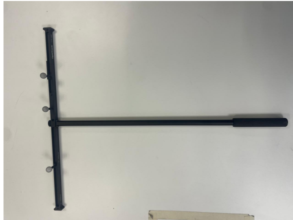
Figura 17: Varilla de calibración utilizada durante el proceso de wanding .
